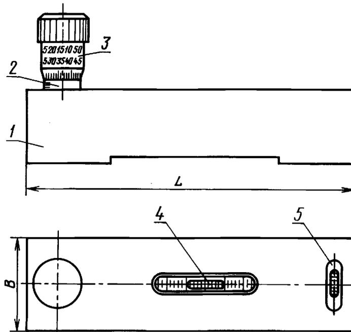
1 — основание; 2 — стержень; 3 — барабан; 4 — продольная ампула; 5 — поперечная ампула
