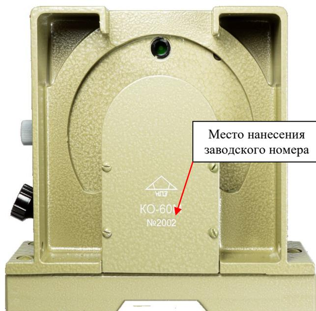
Рисунок 7 – Место нанесения заводского номера на квадрат КО-60М
